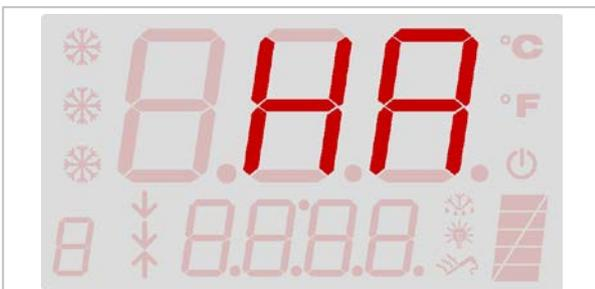
Bei Funktionsstörungen die zur Überschreitung des Stromaufnahmeimits führen, die von der elektrischen Anlage vorgesehen sind, schreitet ein Thermorelais ein, das die Maschine stoppt. Dieser Eingriff wird auf dem Display durch die Anzeige "**HA**" angezeigt. Sollte das Thermorelais einschreiten, muss dieses von Hand rückgesetzt werden. (siehe entsprechendes Kapitel).
