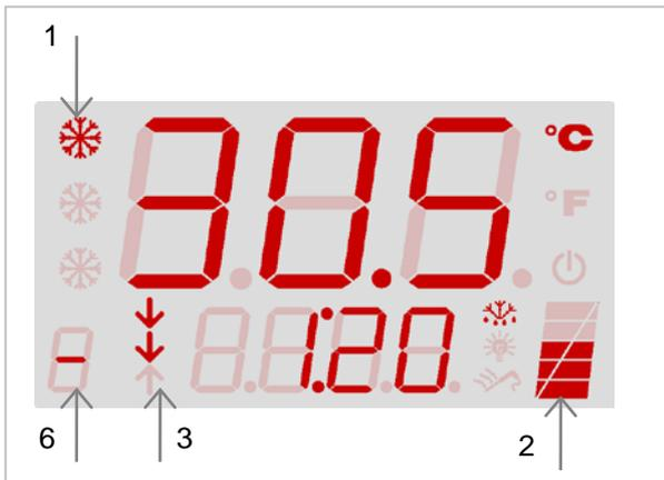
Positiven Zyklus auswählen: . Die entsprechenden Led-Anzeigen des positiven Zyklus leuchten auf (1). Auf den Displays werden die entsprechenden Temperaturwerte der Zellensonde und die Zykluszeit (90 Minuten) visualisiert.
