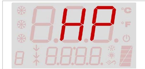
Sollten Umgebungsbedingungen oder Funktionsstörungen zum Überschreiten der Max- oder Mindestwerte im Kühlkreislauf führen, schreitet der Hoch- oder Niederdruckssicherheitsdruckmesser ein und blockiert die Funktion des Gerätes. Sobald wieder ein akzeptabler Druckwert erreicht wird, kann die Maschine erneut in Betrieb genommen werden. Bei einen durch Hochdruck ausgelösten Alarm, erscheint auf dem Display "**HP**" bei einem Niederdruckalarm erscheint auf dem Display "**LP**".
