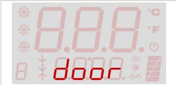
Sollte die Tür geöffnet werden, öffnet sich der Magnetschalter der sich auf der Bedienblende befindet und schaltet während des Schockkühlens oder des Schockfrierens die Verdampfungslüfter aus, gleichzeitig erscheint auf dem Display eine Alarmmeldung; diese Situation kann auch auftreten, wenn die Tür nicht perfekt auf die Bedienblende ausgerichtet ist und nicht perfekt daran anliegt: in diesem Fall wird, befindet sich die Maschine in der **STOPP** Phase der Start eines Zyklus' verhindert.
