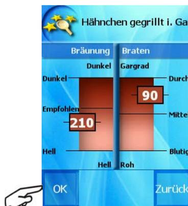
Falls Sie andere Einstellungen der Endwerte fordern (z.B. dunklere und knusprigere Haut bei einem Grillhähnchen), wählen Sie die gewünschte Temperatur im roten Feld des Bildschirms (rechts: Einstellung des Kerntemperaturfühlers/ links: Einstellung Garraumtemperatur). Feineinstellungen können Sie mit den Pfeiltasten vornehmen.
