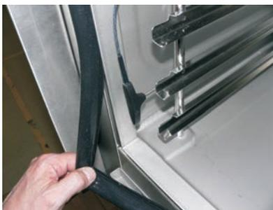
Getrocknete Dichtung wieder ohne Werkzeug einsetzen (wieder zuerst an den Ecken).
