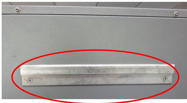
Entfernen Sie die **2 unteren Torx T20-Schrauben** und montieren Sie in dieselben Öffnungen die **2 konischen Gummi-Metall-Puffer M8\*7 inkl. Mutter M4 0.5D**.
