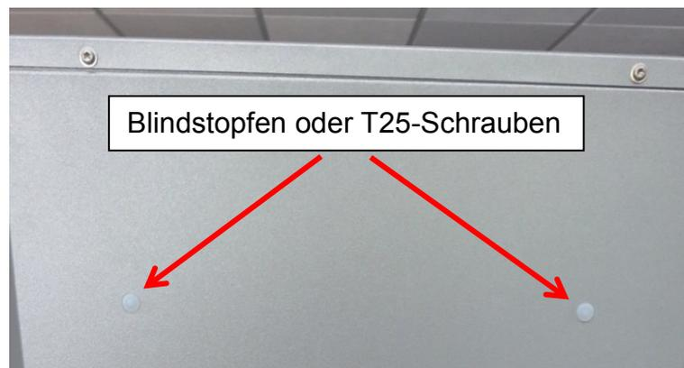
Montieren und befestigen Sie nun die mitgelieferte Wandhalterung mit den dazugehörigen **2 Senkschrauben Kreuzschlitz M5\*10** an das Gerät.
