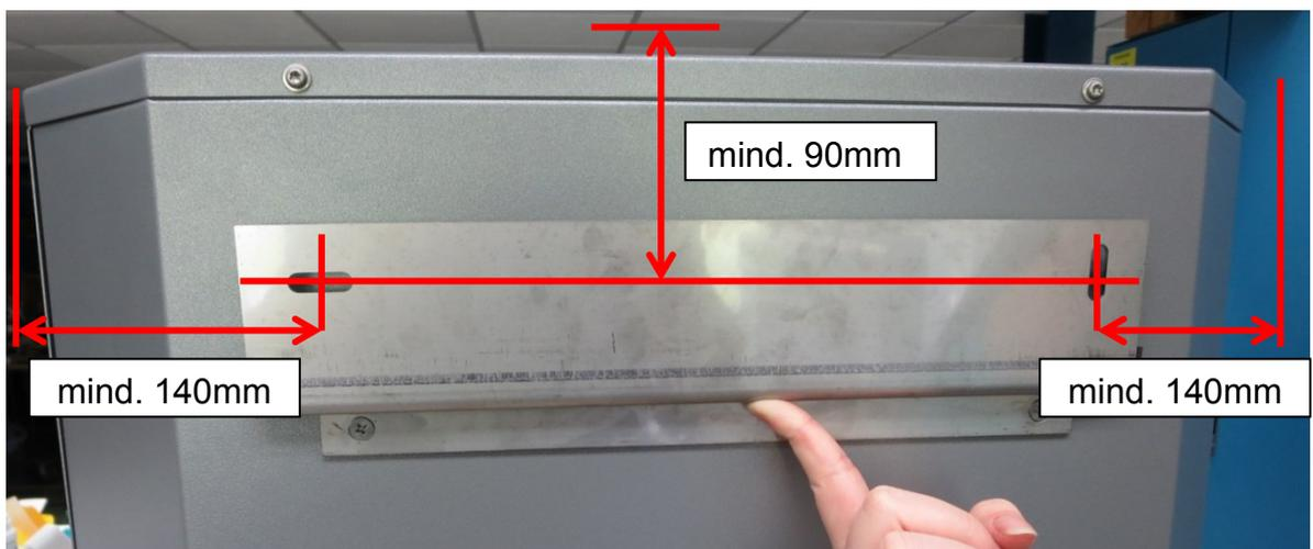
Die 90mm oben gelten als Referenzwert für das einhängen des Gerätes. In der Praxis muss massiv mehr Platz gegen oben (zur Decke) vorhanden sein, da aus der Entlastungsleitung Dampf austritt.
