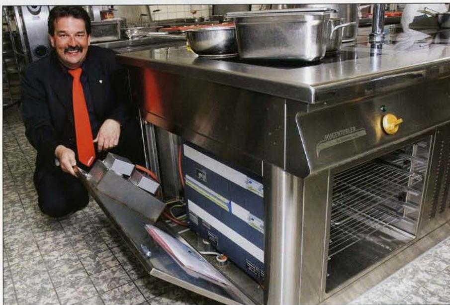
Im Herdunterbau integriert: Hold-o-mat, Tellerwärme-Doppelschubladen, Pfannenablagen, Induktionstechnik. Bruno Dietz von der Hugentobler AG zeigt die Hightech-Module in der Herdanlage.
