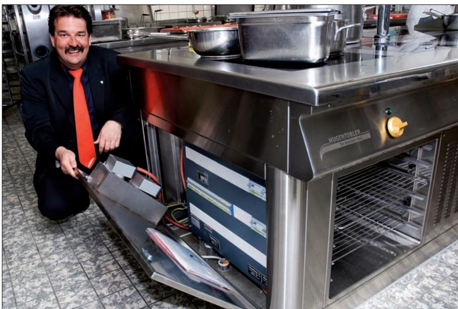
*Sont intégrés dans la partie inférieure du fourneau: Hold-o-mat, doubles tiroirs chauffe-plats, dépôt de poêles, technique à induction. Bruno Dietz de la maison Hugentobler AG montre les modules high-tech intégrés au fourneau.*
