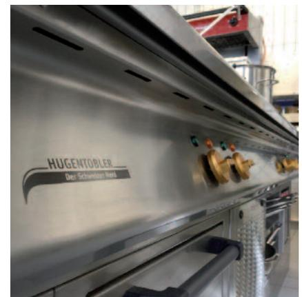
Seitlich eingelassen sind Hold-o-mat, Bratofen und Pfannenfächer. Die abklappbaren Seitenblenden garantieren einen einfachen Zugriff zur Herdtechnik und die schräg angehobene Schaltblende sorgt für eine mühelose Bedienung der Leistungsstufen.
