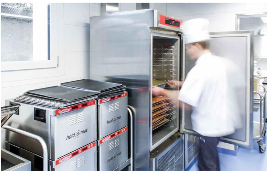
Mit dem leistungsstarken Frigojet werden vorproduzierte Speisen professionell schockgefrostet oder schnellgekühlt.
