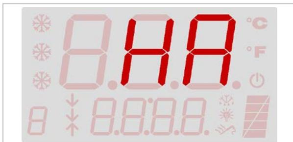
Si, à cause d'anomalies de fonctionnement, l'installation électrique a une consommation de courant supérieure aux valeurs admises, un relais thermique interviendra pour arrêter l'appareil. Telle intervention est signalée par l'affichage sur l'écran du message **"HA"**. Dans le cas où le relais thermique soit intervenu, le relais thermique doit être réenclenché manuellement (voir chapitre spécifique).
