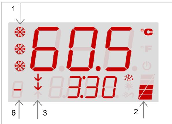
Sélectionner le cycle négatif :
