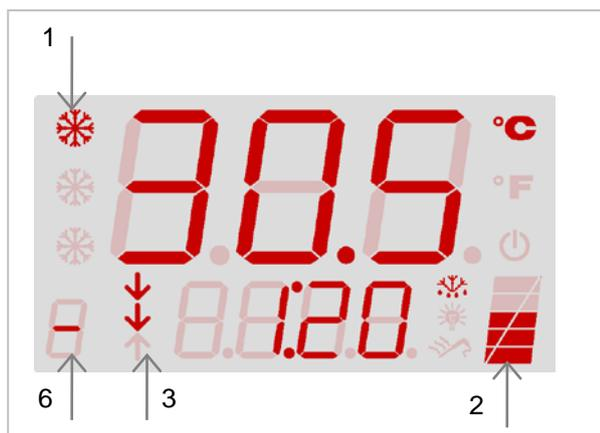
Sélectionner le cycle positif : . Les leds relatives au cycle positif s'allument (1). Les écrans affichent respectivement la température lue par la sonde cellule et le temps du cycle (90 minutes).
