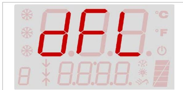
Ce micro-interrupteur, placé sur le déflecteur d'évaporation, désactive le fonctionnement de l'appareil, en cas d'ouverture du déflecteur pour inspection de l'évaporation ou bien celle des ventilateurs. La fermeture du déflecteur suivie de la cessation de l'alarme sur le display, consent de nouveau le normal fonctionnement de l'appareil
