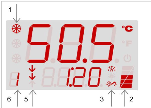
Sélectionner le cycle positif :
