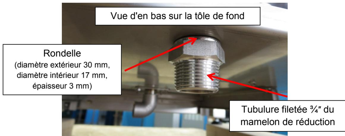
Vissez le manchon hexagonal 1/4" - 1/4" par le haut sur la tubulure filetée 1/4" du mamelon de réduction. Maintenez ainsi le mamelon de réduction 3/4" - 1/4" avec un outil avec SW30 et le manchon hexagonal 1/4" - 1/4" avec un outil avec SW22.
