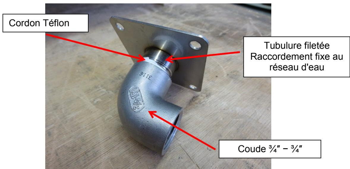
Appliquez un peu de silicone sur la bride du raccord d'évacuation fixe afin de garantir l'étanchéité ultérieure.
