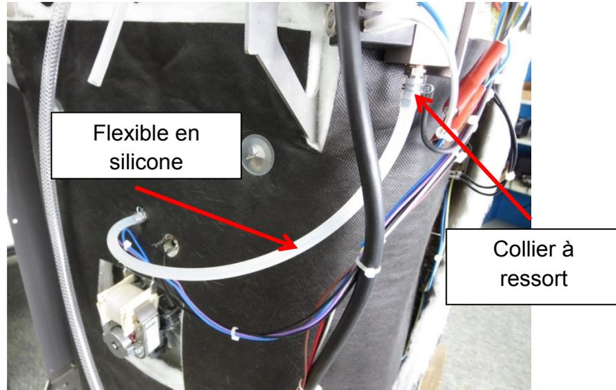
Retirez maintenant le flexible en silicone supérieur qui mène au réservoir d'eau douce et sortez-le du trou. Placez ensuite, à partir de l'intérieur du réservoir d'eau douce, le bouchon fourni dans le trou.
