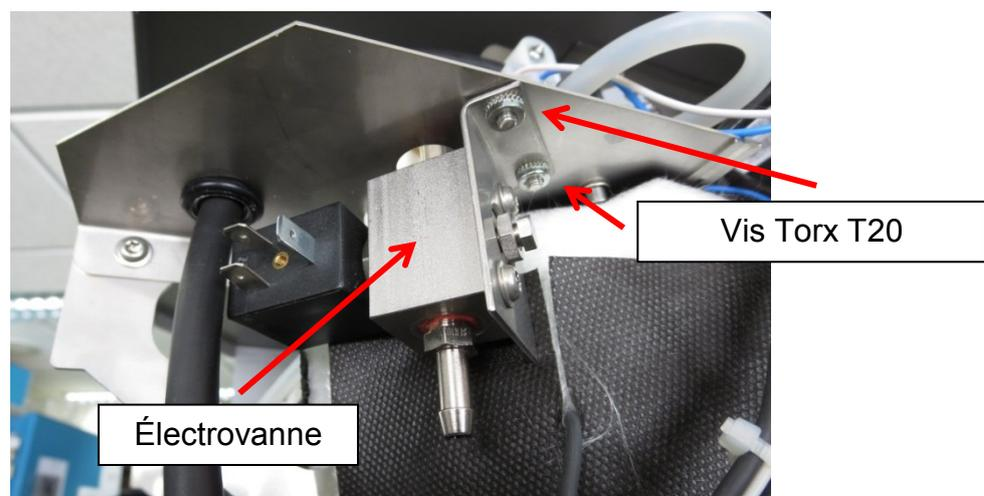
Placez le collier à flexibles UNEX sur le flexible à boissons et ce dernier sur le mamelon de réduction supérieur de l'électrovanne. Serrez la vis du collier à flexibles UNEX de manière à ce que le raccord de flexibles soit étanche.
