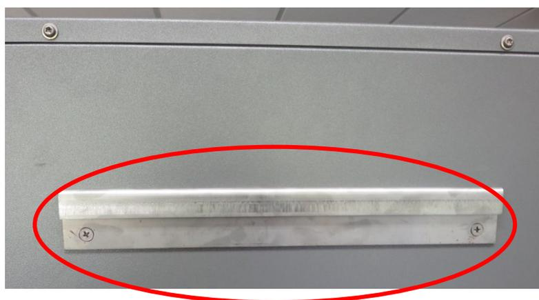
Retirez les **2 vis Torx T20 inférieures** et montez dans ces mêmes ouvertures les **2 tampons caoutchouc-métal coniques M8\*7, écrou M4 0.5D inclus**.
